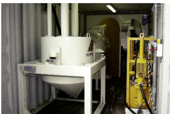
Bei uns kommt modernste Technik zum Einsatz. Computer-gesteuerte Kompaktinjektionsanlagen integriert in Container mit vollautomatischer Registrierung.
