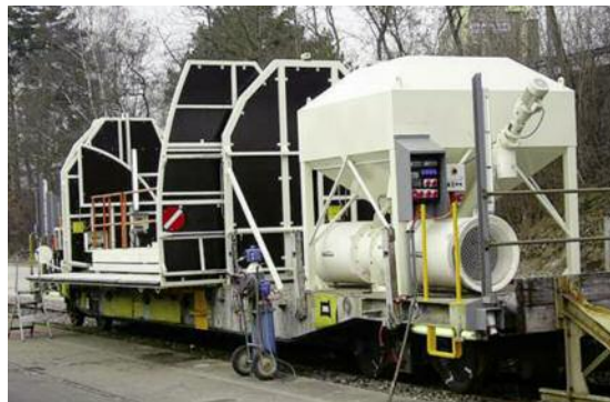
oben: Spezialkonstruktion Mehrblattfräse für Profilerweiterungen
